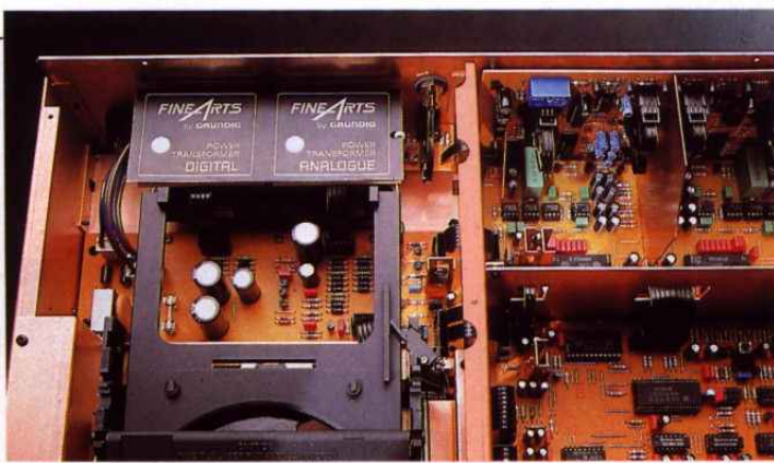
Spitzentechnologie in verkupferten Messingchassis.
