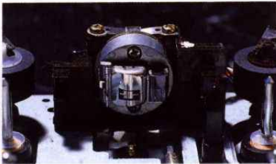
Rotating heads für beste Azimut-einstellung.
